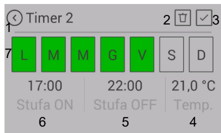
Fig. 103: Predisposizione degli orari di riscaldamento
