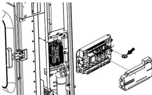
Fig. 86: Sostituzione della batteria tampone
