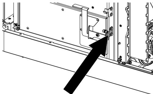
Fig. 82: Regolazione dello sportello del cassetto della cenere sul lato di chiusura
