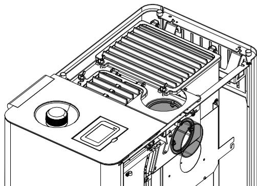
Fig. 19: Componenti scambiati
