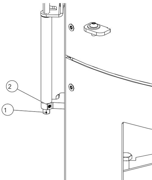
Fig. 79: Regolazione della forza di chiusura dello sportello
