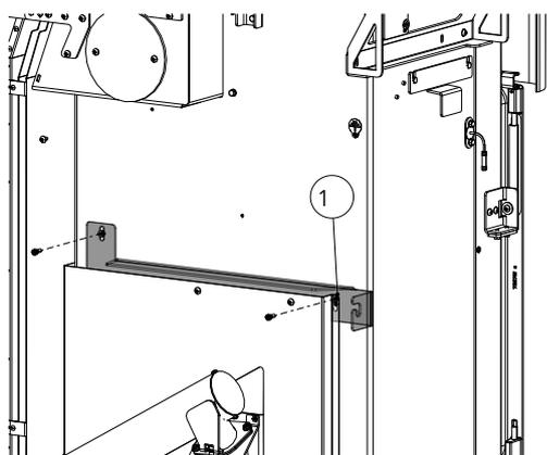
Fig. 12: Montaggio del supporto posteriore dell'HMS
