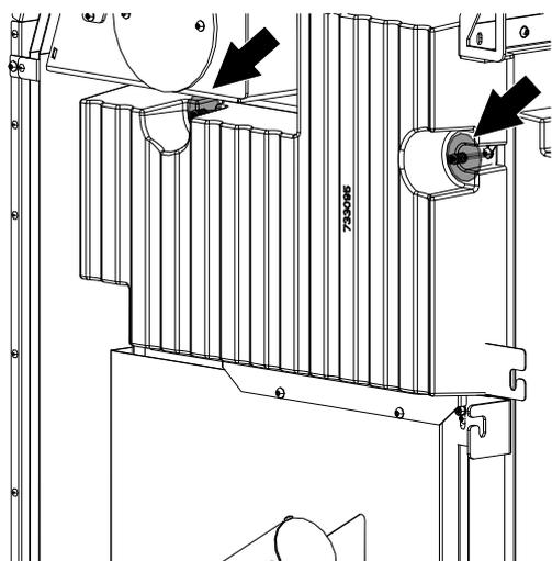
Fig. 13: Montaggio della pietra posteriore dell'HMS
