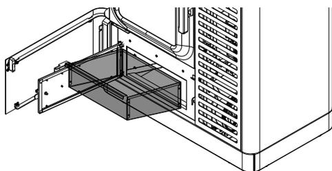
Fig. 97: Rimozione del cassetto della cenere
