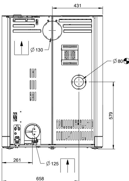
Fig. 32: Collegamento dell'alimentazione esterna di aria comburente
