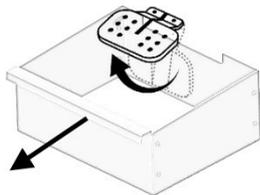
Fig. 48: Rimozione del vassoio per la cenere
