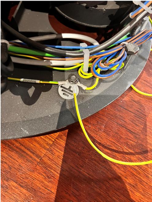
Fig. 27: Collegamento della messa a terra centrale
