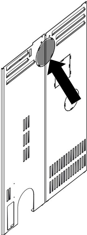
Fig. 20: Rimozione della parte perforata
