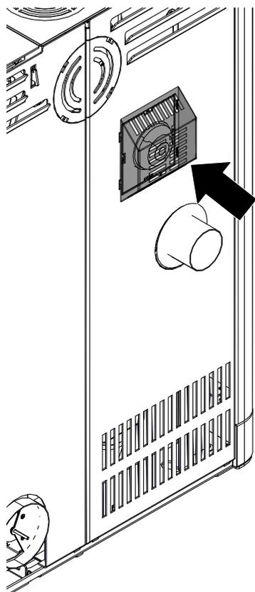
Fig. 31: Fissaggio del coperchio alla parete posteriore
