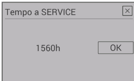
Fig. 67: Intervallo di tempo senza manutenzioni scaduto
