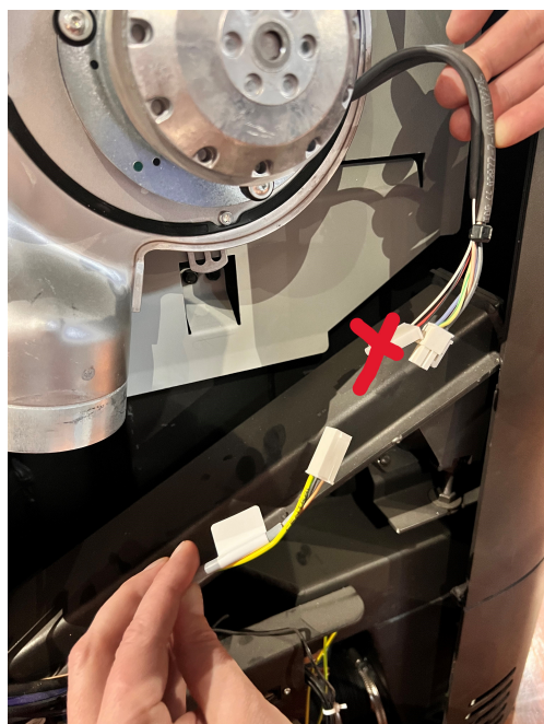
Fig. 23: Collegamento del cavo
