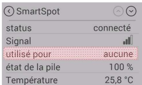
5) Il est ensuite possible de sélectionner l'utilisation souhaitée du capteur de température.
