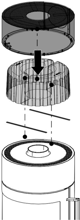
Abb. 1: HSM-Steine montieren
