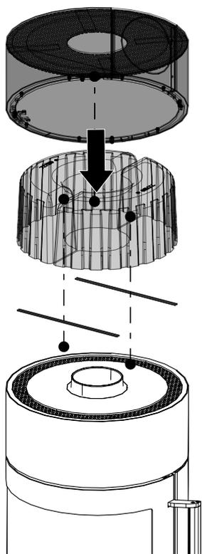
Fig. 1: Installer les pierres HSM
