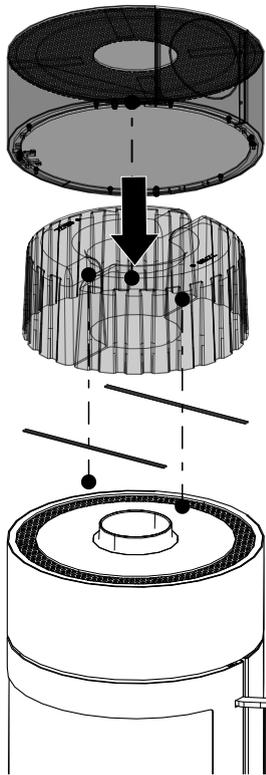
Fig. 1: Montaggio delle pietre HMS
