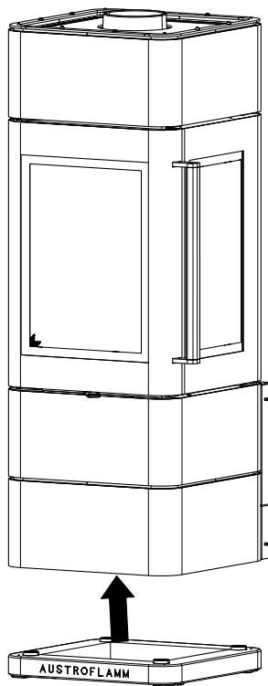
Fig. 1: Rimozione della base in legno
