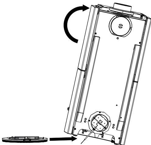
Fig. 5: Basculer le poêle à bois sur le côté
